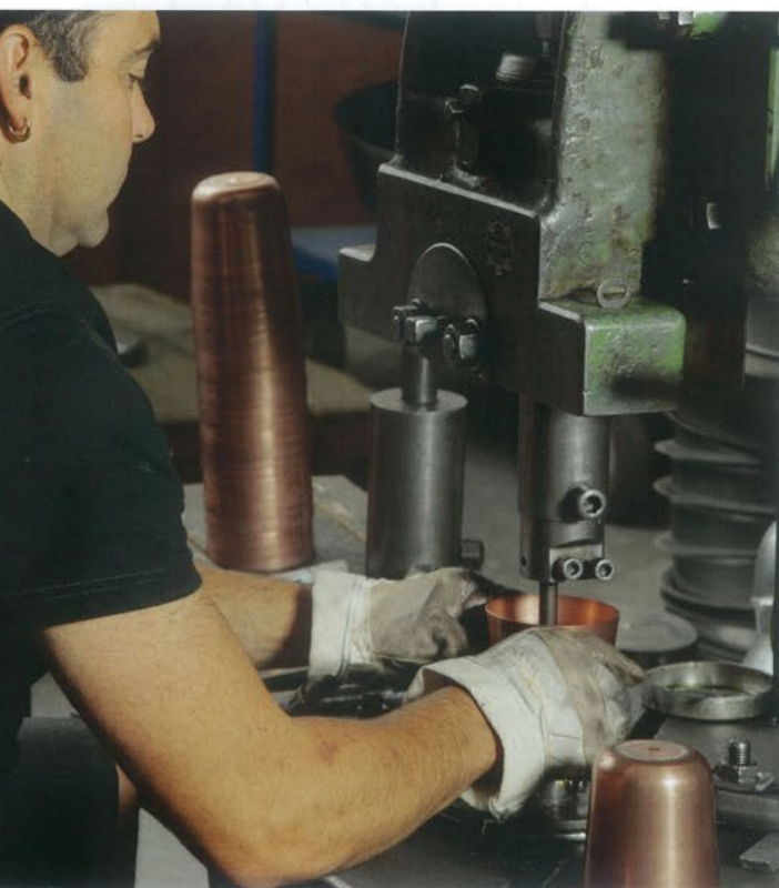
◀ In den Schirm wird ein Loch für die Kabeleinführung gebohrt, auch dies exakt und per Hand.
