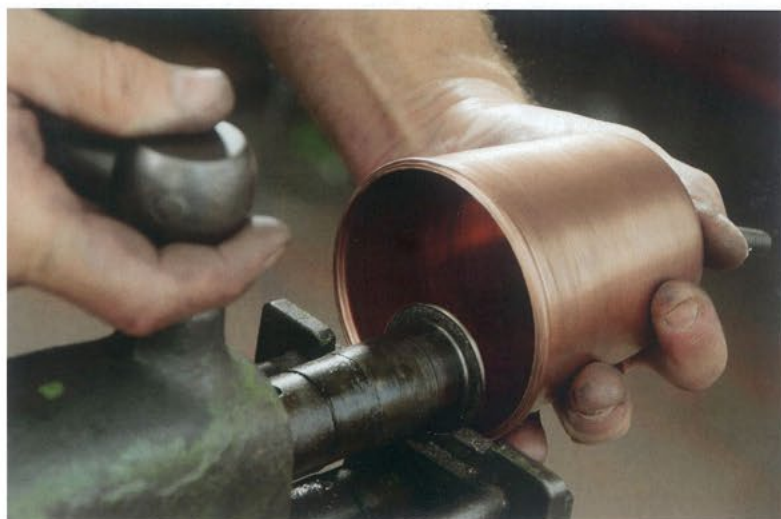
▼ Details wie die Rändelung werden herausgearbeitet, bevor es dann anschließend an die Oberflächenbearbeitung geht.
